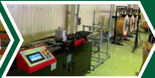
Выпрямление, резка медной трубы
