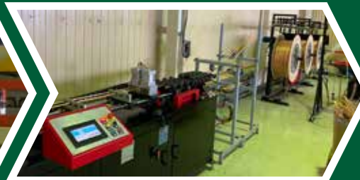
Выпрямление, резка медной трубы
